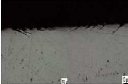
*Figure 34: Multi-fissuration en fretting-wear pour des conditions proches de la transition [74].*
