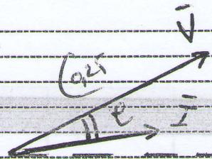
(0,25)  $\bar{I} = 44 \angle 15^\circ$ ;  $\bar{V} = 220 \angle 45^\circ$
