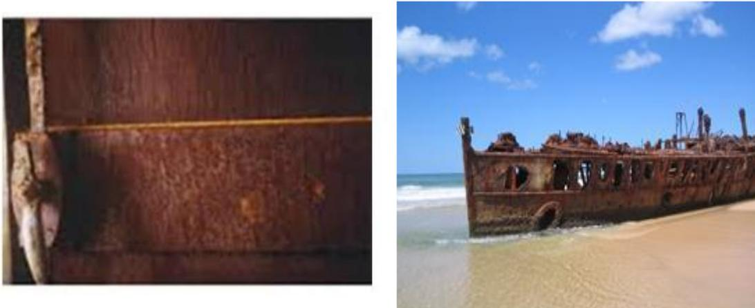
**Figure I-5 :** Corrosion généralisée : exemple d'une porte et d'un bateau corrodés.
