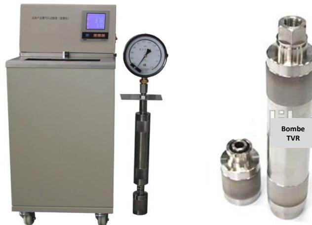
Figure V.5. Appareil de mesure de la TVR
