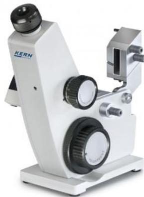
**Figure V.3. Réfractomètre d'Abbé**
