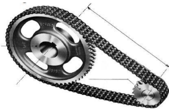
Figure 1. 22 Transmission par lien flexible : pignons-chaîne
