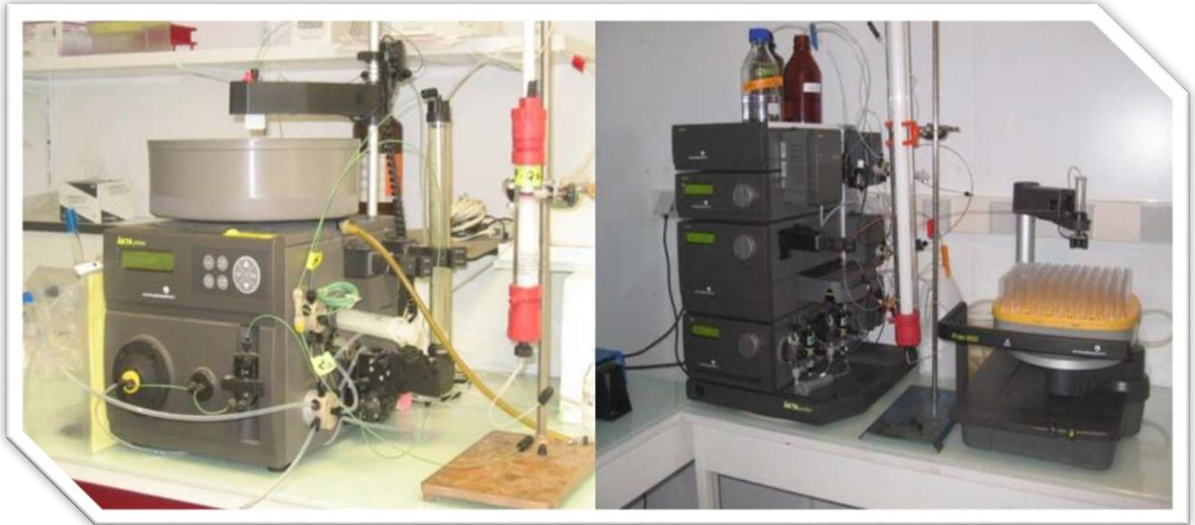
Système de purification (deux modèles : AKTA PRIME et GRADIFRAC).
