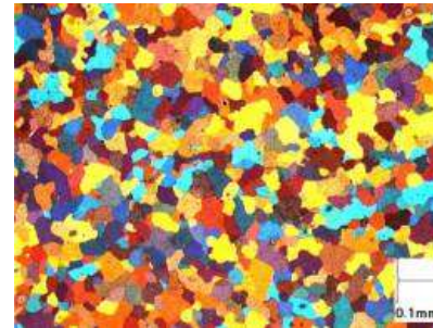
Structure d'un acier inoxydable après une attaque colorante - Grossissement 100X
