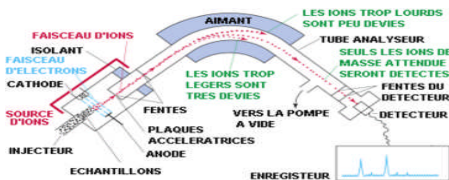
Figure 27 : Schéma d'un spectromètre de masse type.
