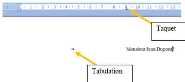
Le taquet est placé par un clic dans la règle. La tabulation est activée avec la touche tabulation du clavier. La touche tabulation permet de débiter le texte à l'aplomb du taquet. Recommandation : mettre les taquets avant de taper le texte sur la ligne.
