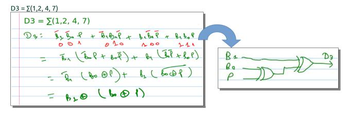
Nous avons conçu un circuit de détection d'erreur pour un bus à 3 bits (B1, B0, P), maintenant si on rajoute un quatrième bits, comment allons nous concevoir notre circuit?
