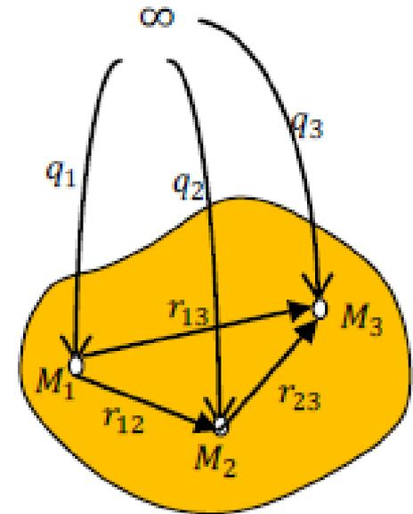
L'énergie électrostatique d'un ensemble de n charges ponctuelles est donc :
