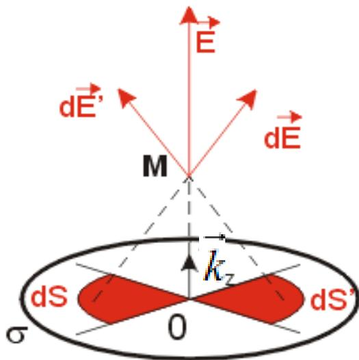
En faisant composition vectorielle des champs élémentaires  $d\vec{E}$  et  $d\vec{E}'$  créés par les éléments de surface  $dS$  et  $dS'$  symétriques par rapport à  $O$ , on voit que le champ est porté par  $\vec{k}$
