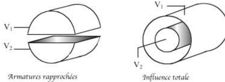
En général, les deux armatures sont séparées par un matériau isolant (un diélectrique, ex : le vide), ce qui a pour effet d'accroître la capacité du condensateur.
