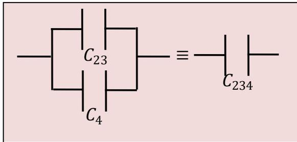
Les capacités  $C_1$ ,  $C_{234}$  et  $C_5$  peuvent être remplacées par  $C_{12345} = C_{AB}$  :
