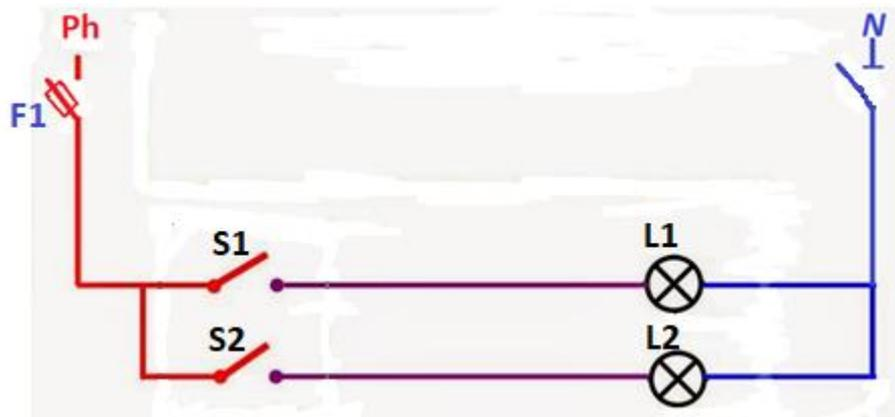
Figure III.7. Schéma développé d'un double allumage.
