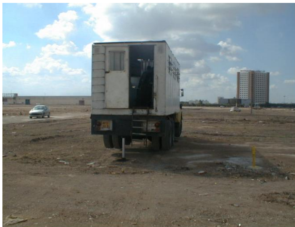
(a). Camion porteur du statique (CPT)
