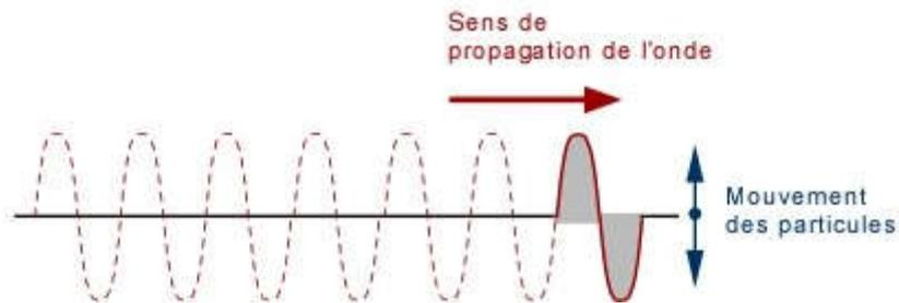
La structure interne de la Terre, ainsi que l'état et la densité de la matière, ont été déduits de l'analyse du comportement des ondes sismiques. Les ondes P se propagent dans les solides, les liquides et les gaz, alors que les ondes S ne se propagent que dans les solides. On sait aussi que la vitesse de propagation des ondes sismiques est proportionnelle à la densité du matériel dans lequel elles se propagent.
