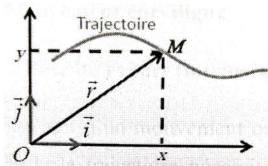
Figure 2.7 Représentation du vecteur position dans un mouvement curviligne
