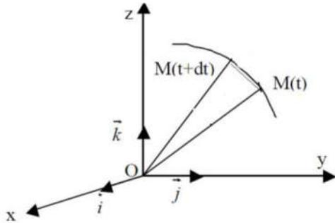
Figure 2.2 : Représentation d'un déplacement infinitésimal
