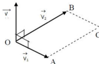
Figure 1.10 : Représentation du produit vectoriel en appliquant la règle du tirebouchon
