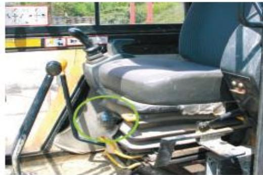
Figure III. 14 : Réduction des vibrations par réglage du siège
