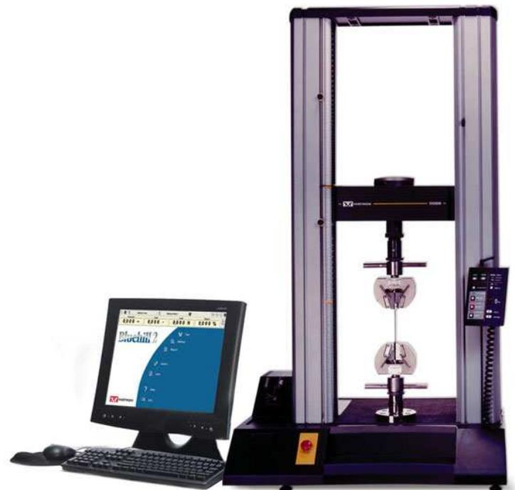
Figure I.1: Machine d'essai de traction
