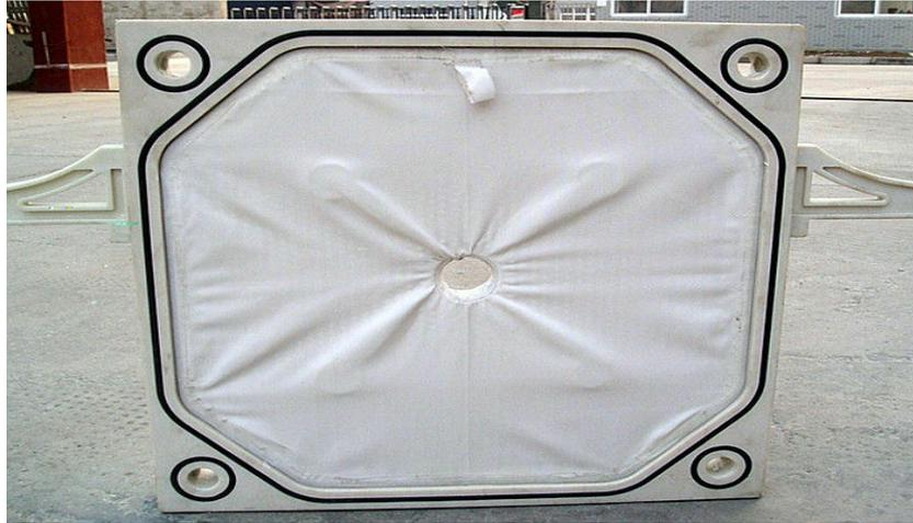
Figure 41 : Filtre à feuille utilisé lors de la clarification.
