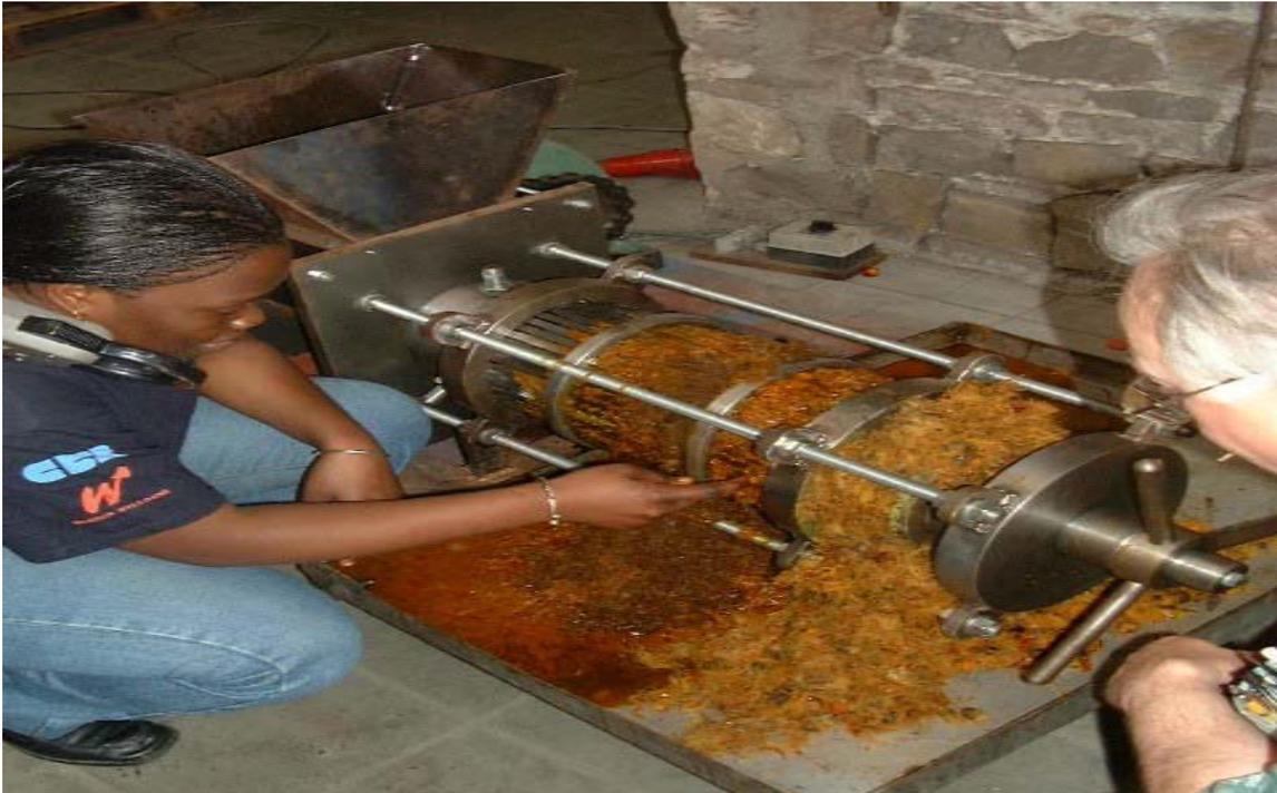
**Figure 38:** Extraction de l'huile de palme par passage dans une presse à vis à alimentation continue (presse horizontale), à l'échelle pilote.
