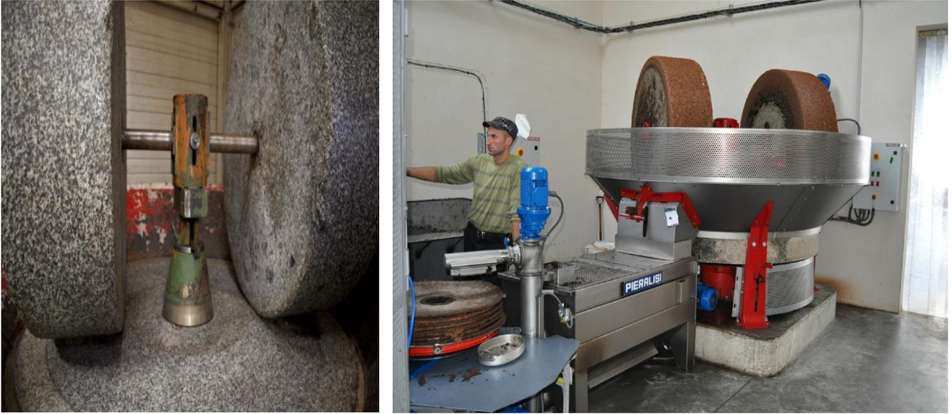
**Figure 35 :** Meule de moulin en pierre utilisé pour le broyage des olives.
