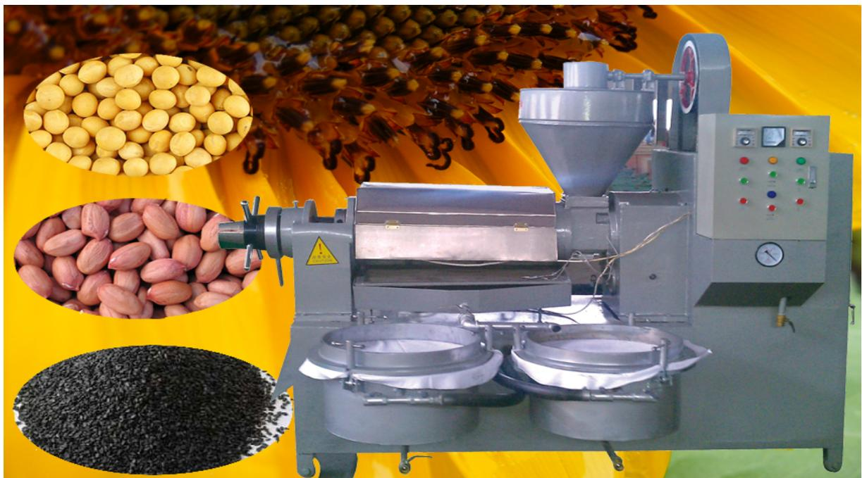
**Figure 37:** Presse à vis à alimentation continue pour l'extraction d'huile d'oléagineux.
