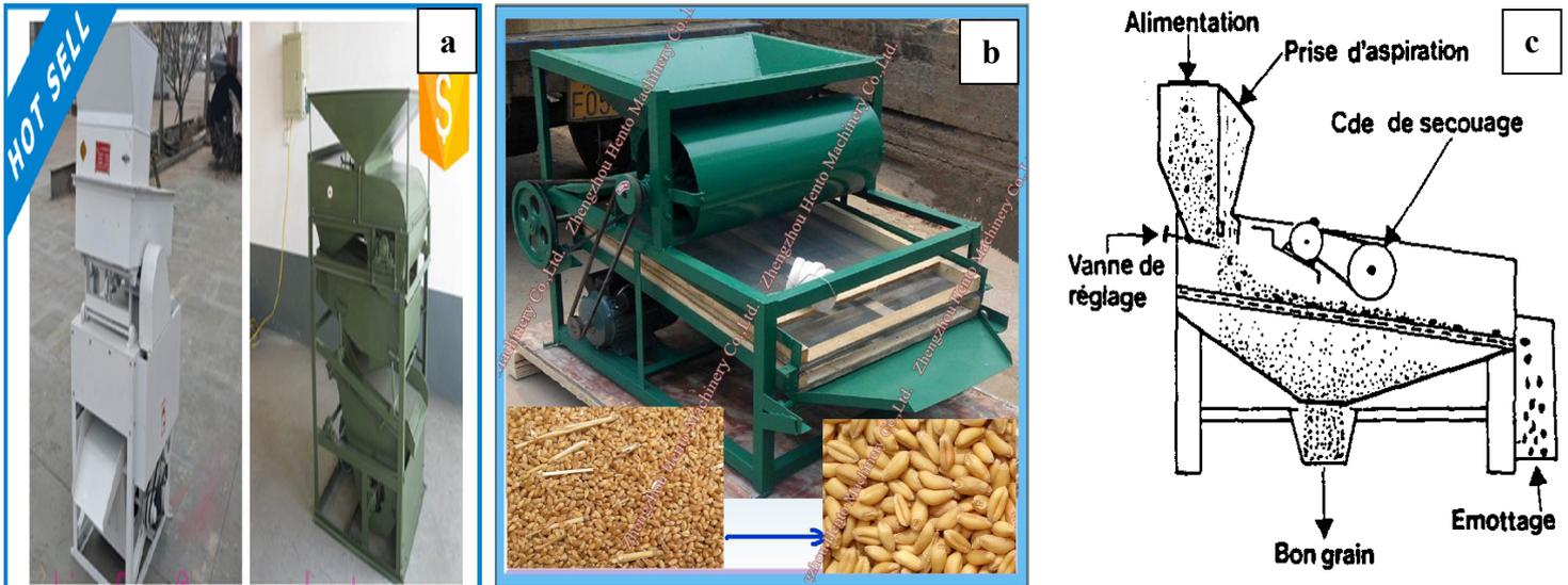
**Figure 30:** Photographies de : a : épierreur, b : Tamis vibrant de nettoyage c : Tambour cribleur de pré-nettoyage.
