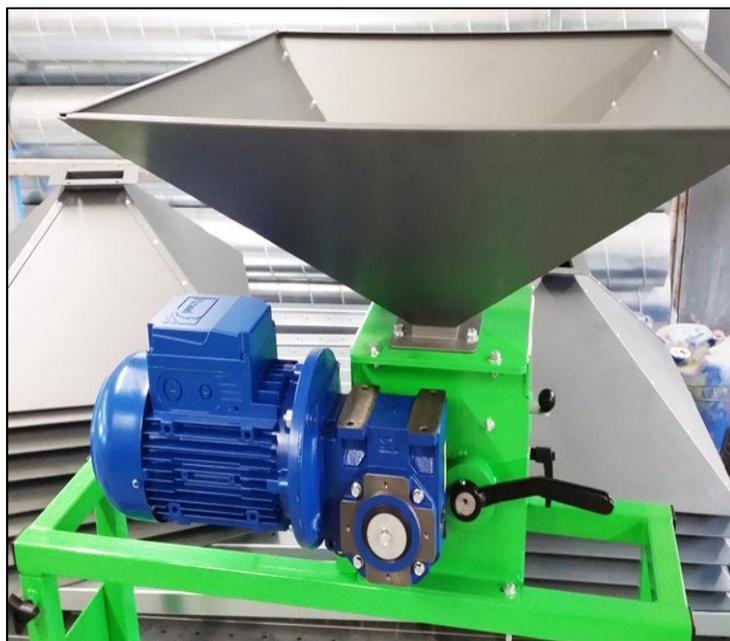
**Figure 34 :** Aplatisseurs à cylindres lisses pour obtenir des flocons.
