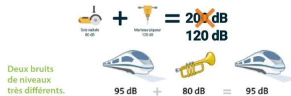
Figure 4.13 : Les règles d’addition des niveaux du bruit si l’écart est supérieur à 10 dB (Source : Cloud, 2015)
