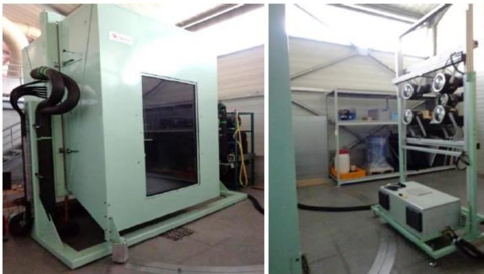
Figure 1.9 : Appareil de mesure du facteur solaire des éléments translucides de l'enveloppe du bâtiment (Source : Auteur, 2017)
