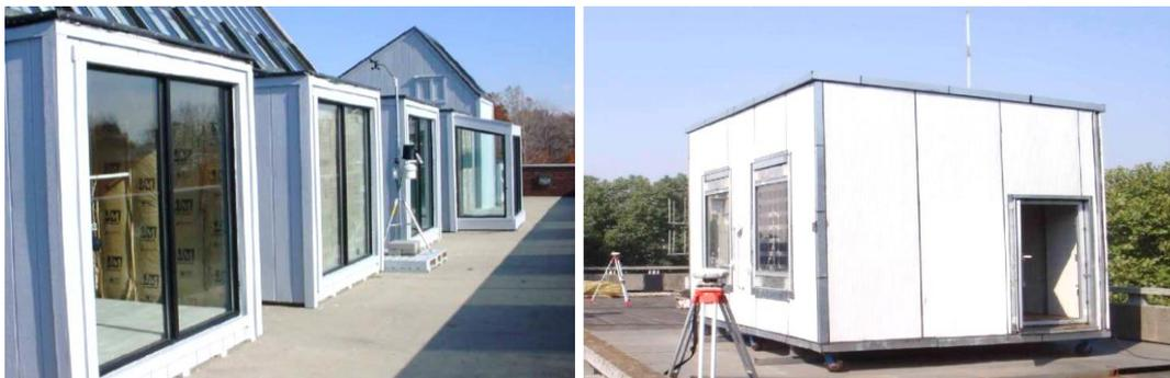
Figure 1.11 : Exemple d'une étude expérimentale par des cellules tests à une échelle réelle
