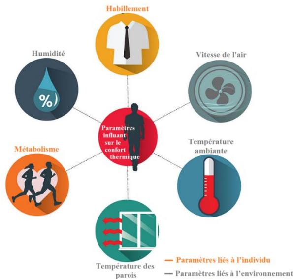
Figure 2.1 : Les paramètres influant sur le confort thermique
