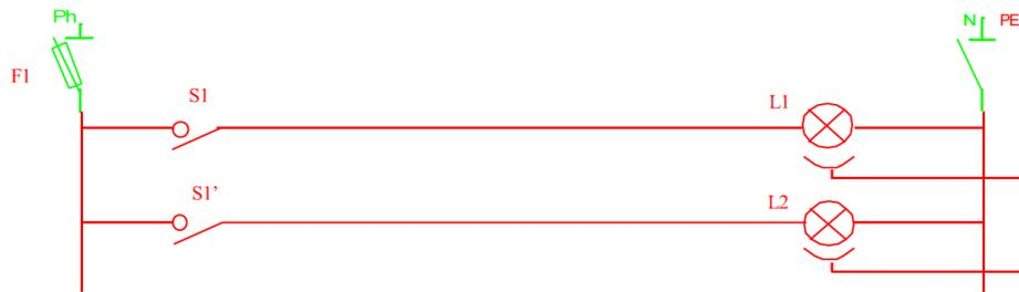
Figure IV. 7 : Schéma développé d'un double allumage
