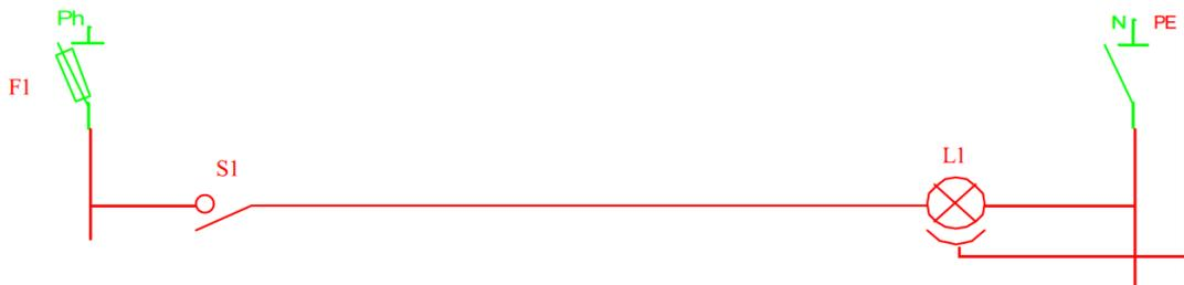
Figure IV. 2 : Schéma développé d'un simple allumage
