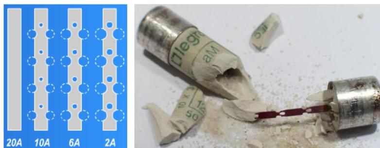
Figure II. 39 : Élément fusible calibré
