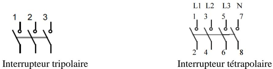
Figure II. 9 : Symbole de l'interrupteur tripolaire et symbole de l'interrupteur tétrapolaire
