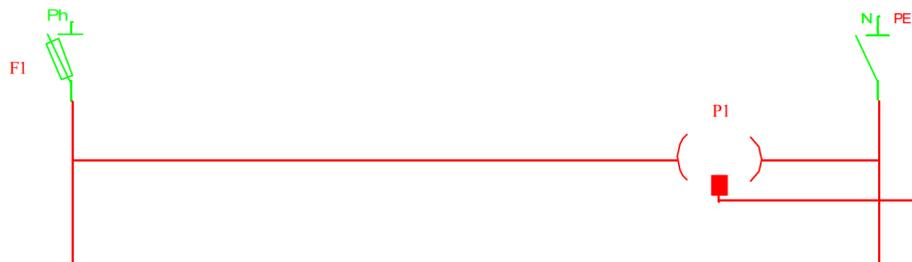
Figure IV. 13 : Schéma développé d'un raccordement électrique d'appareils mobiles
