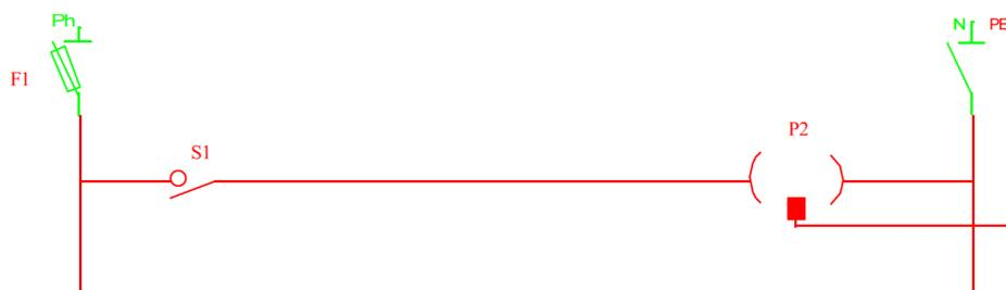
Figure IV. 15 : Schéma développé d'un raccordement électrique d'appareils d'éclairage mobiles via une prise commandée
