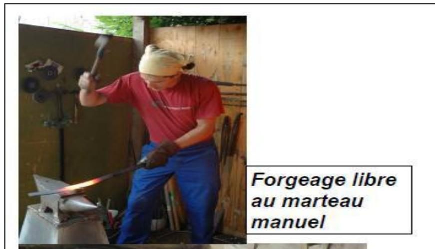
*Figure II.5 : Forgeage libre au marteau manuel [6]*
