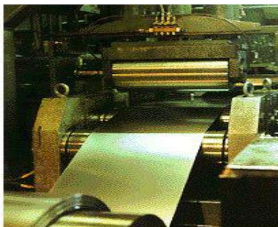
Laminage à froid de tôle fine
