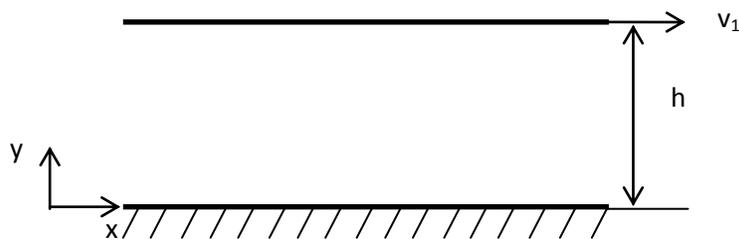
Figure 4.1 Ecoulement entre deux plans parallèles
