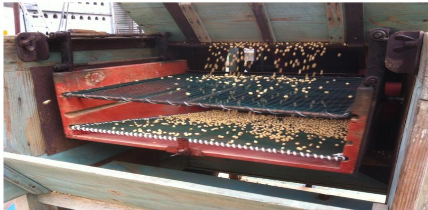
**Figure 74** : Schéma et exemple d'un nettoyeur-séparateur
