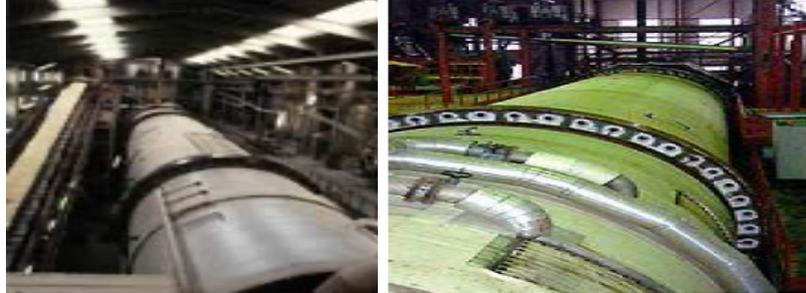
**Figure 18:** Diffuseur horizontal à tube tournant
