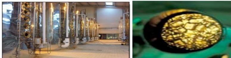
Figure 28 : Système de cristallisation en sucrerie
