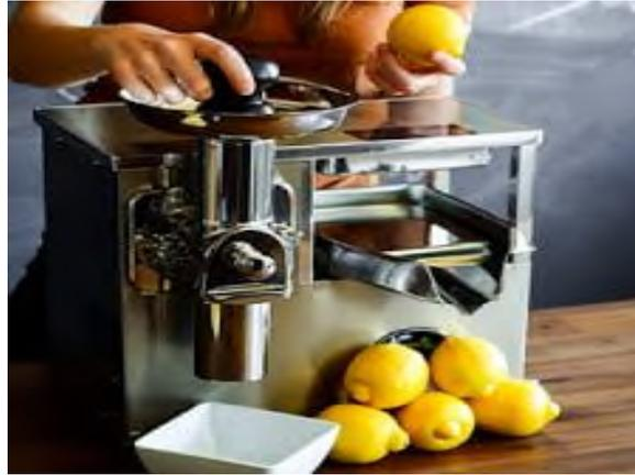
**Figure 13.** Extraction par pressage.
