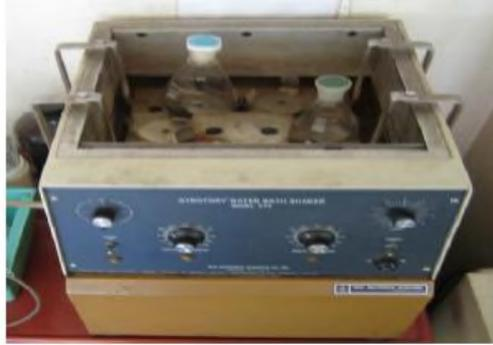
**Figure 21.** Photographie de l'agitateur secoueur utilisé pour l'extraction batch.
