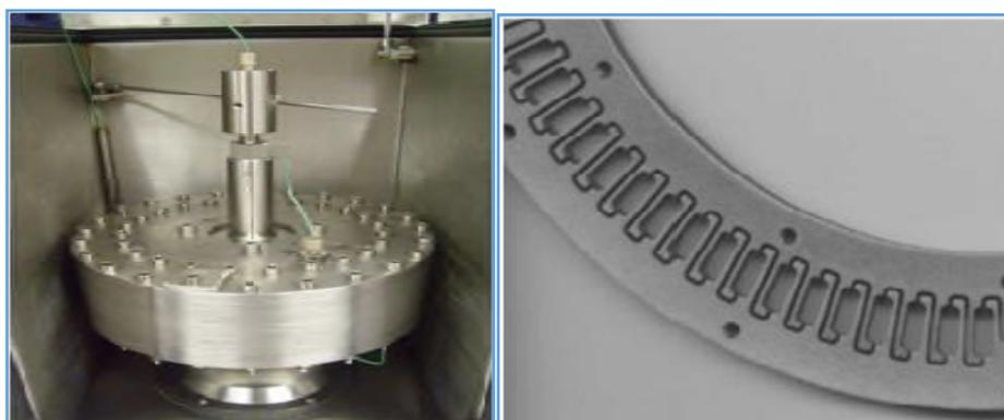
**Figure 55.** Photographie d'une colonne de 200 mL d'un appareil Fast CPC et détail d'un des disques constitutifs de la colonne.
