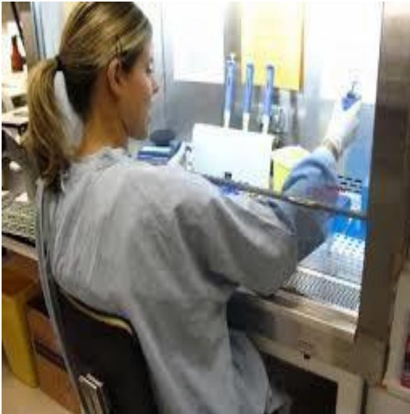
Tout travail impliquant des matières dangereuses, tels des solvants, des contaminants, des produits volatils, des acides et bases concentrées doit être effectué sous une hotte ou un système de captage des contaminants.
