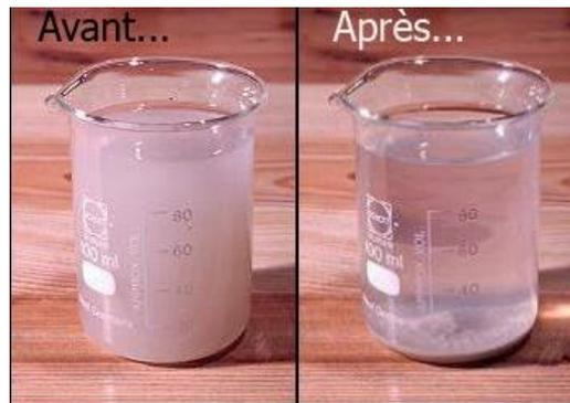
Le système constitué par une phase quelconque dispersée dans une phase fluide s'appelle suspension ou pulpe si la phase dispersée est un solide, émulsion si c'est un liquide dans un autre liquide. Le fluide dans lequel se fait la dispersion est appelé la phase continue.
