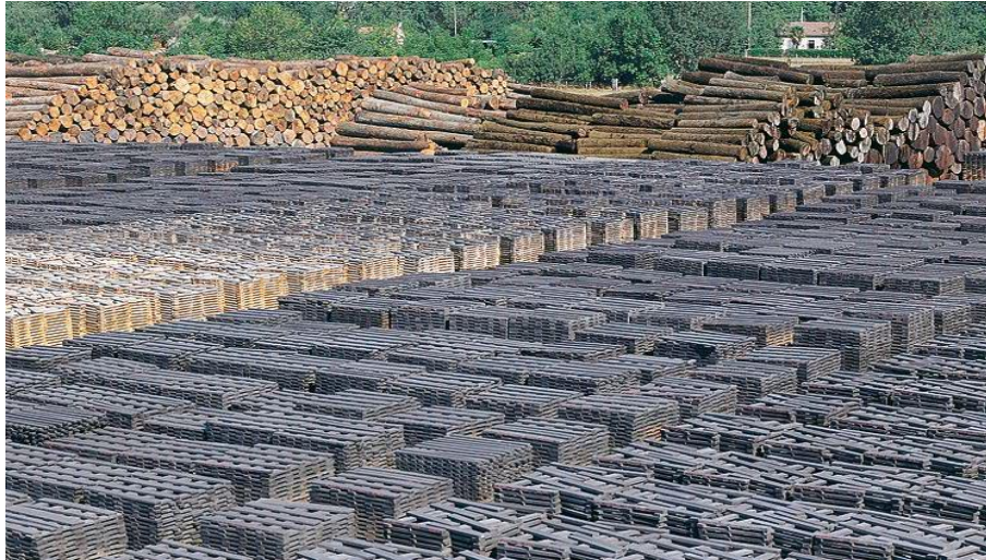
Figure IV.2. Séchage de bois
