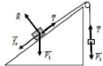
A la limite de glissement vers le haut on a  $m_2 = m_{2max}$ . Le file est inextensible et de masse négligeable  $T_1 = T_2 = T$ . La force de frottement est donnée par :  $f_s = \mu_s R = \mu_s m_1 g \cos \alpha$ . on remplace dans (1), et (3) ensuite on additionne (1)+(2), ceci donne :
