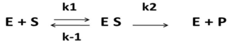
Selon ce modèle, lorsque la concentration de substrat devient suffisamment importante afin de capter toute l'enzyme sous forme ES , la deuxième étape de la réaction devient **limitante** et la réaction globale devient insensible aux augmentations supplémentaires en concentration de substrat.
