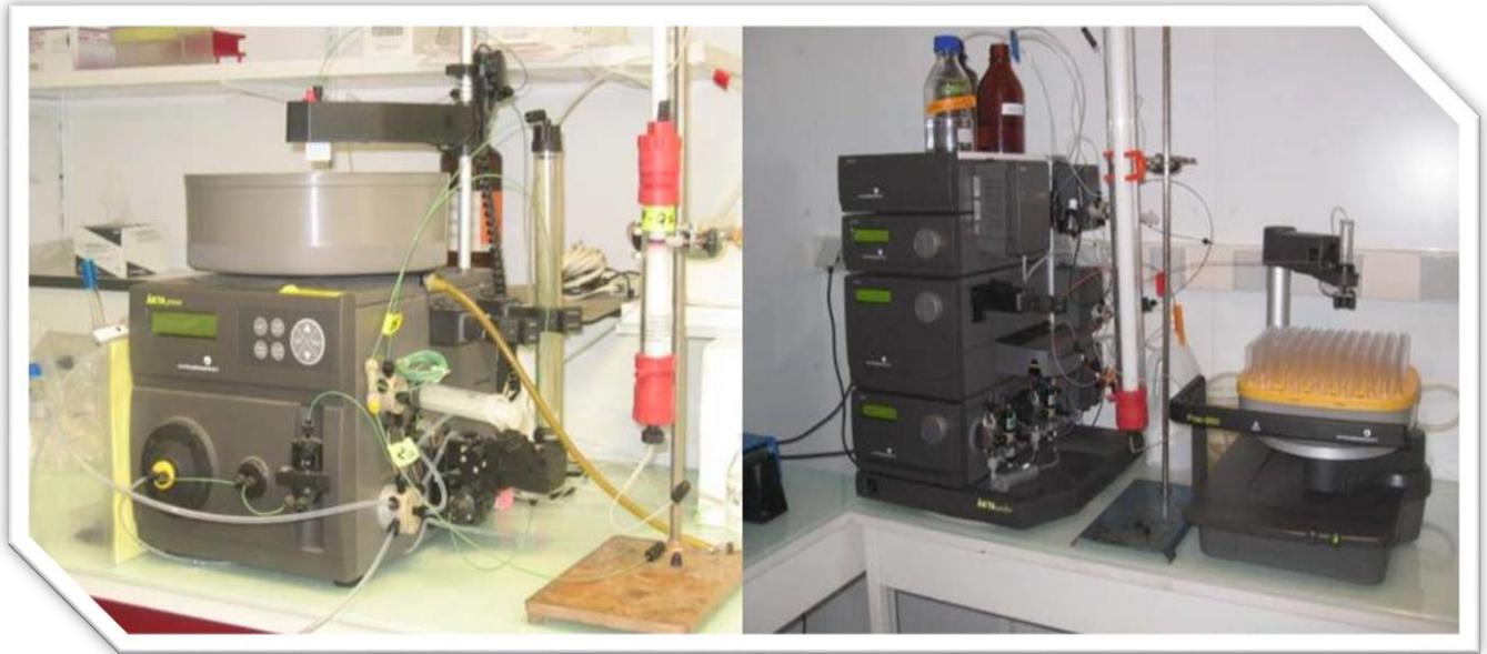
Système de purification (AKTA PRIME et GRADIFRAC).
