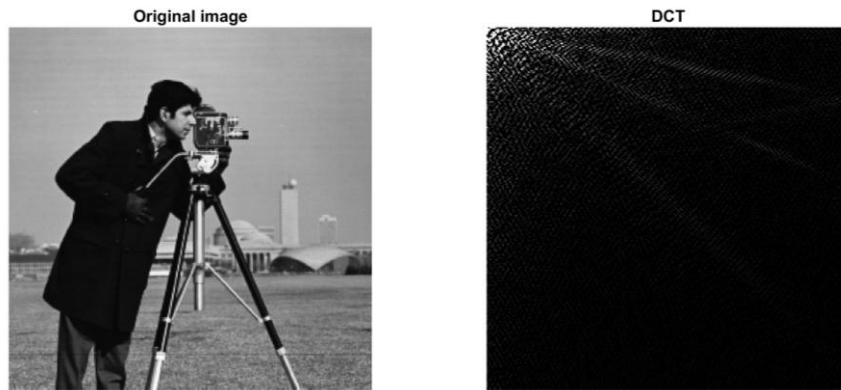
Figure 5.3 Transformée en cosinus de l'image (a) image originale (b) sa DCT
