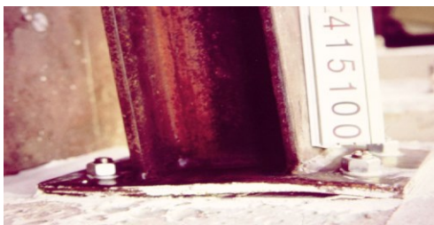
Figure 120: Cas de platine déformables
