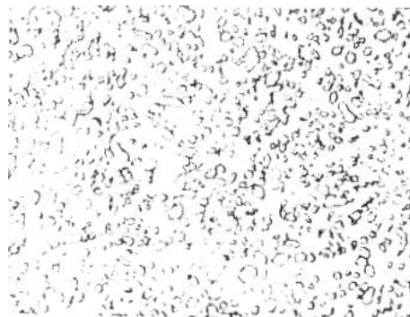
V =500:1 Perlite globulaire. La cémentite de la perlite. Les sphères formées par la cémentite de la perlite ne sont pas réguliers. (attaque avec \text{HNO}_3 à 1%). (fig.16)
