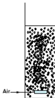
L'ascension du nuage de bulles de gaz induit un **mouvement** ascendant de la phase liquide au centre de la colonne et descendant au voisinage de la paroi.
