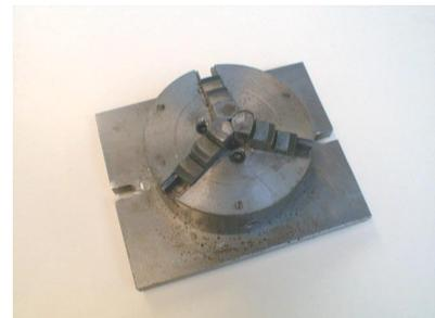
Le mandrin dédié au perçage sur une machine conventionnelle.
