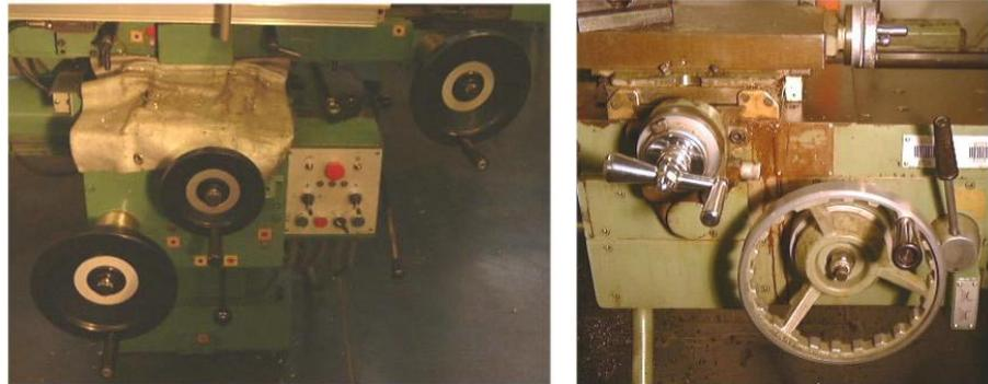
Des moteurs permettent aussi de choisir des vitesses d'avance suivant les axes de déplacements. Le choix de ces vitesses s'effectue par l'intermédiaire d'une boîte de vitesse mécanique.
