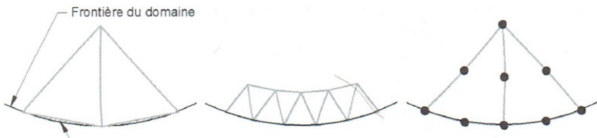
Figure 10 : Erreurs de discrétisation et raffinement de maillages
