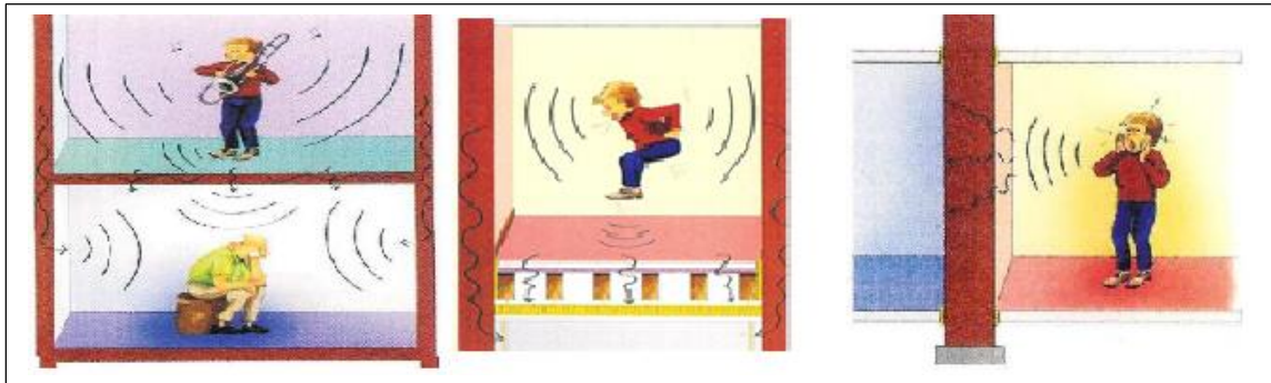
Figure 05 : types de bruits à l'intérieur du bâtiment,
