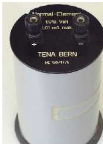
Figure I.2 : Pile de Weston.
