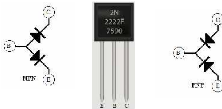
Figure IV.13 : Transistor NPN et schéma équivalent.
