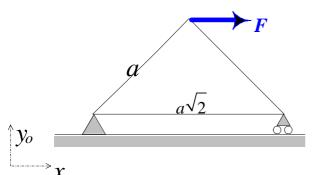
Pour les calculs numériques nous utiliserons les données suivantes : a=1 m et F=30 KN
