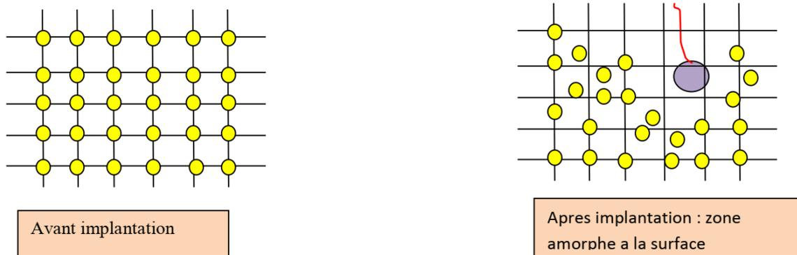
**Figure 3.7** Création d'une zone amorphe à la surface du semi-conducteur par le bombardement ionique.
