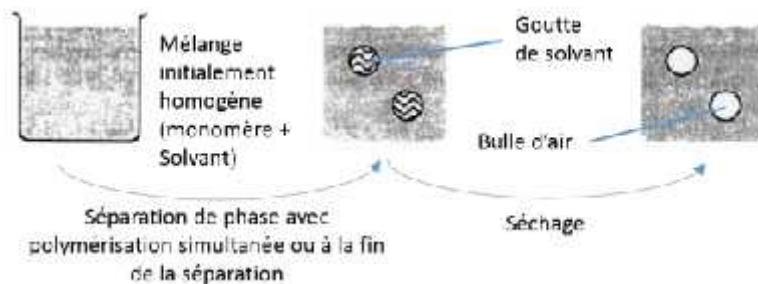
Figure 28. Technique d'élaboration de mousse par séparation de phase [13]
