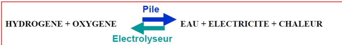
Figure IX.2 Réaction de conversion réversible entre vecteurs hydrogène et électricité
