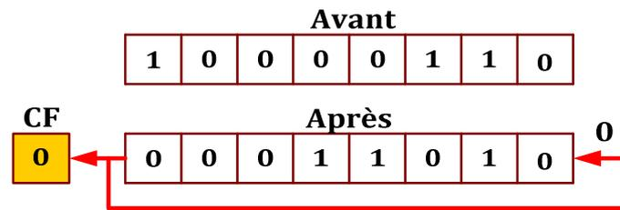
**ROR** : Les bits sont décalés vers la droite, 1 ou CL fois, le bit de poids faible sortant est injecté dans CF et dans le bit de poids fort.
