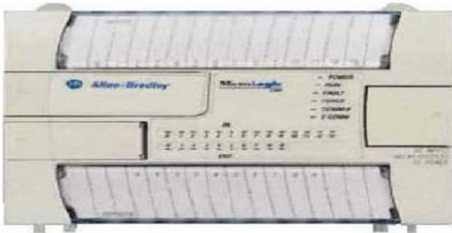
Figure II.5 Exemple d'un automate de type compact
