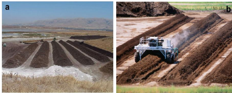
Figure 2.20 : Compostage par andain (a) ; Machine pour retourner et aérer les andains (b)
