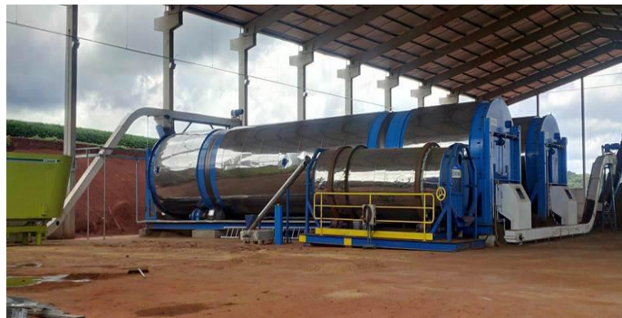
Figure 2.22 : Equipement utilisé dans le compostage en réacteur
