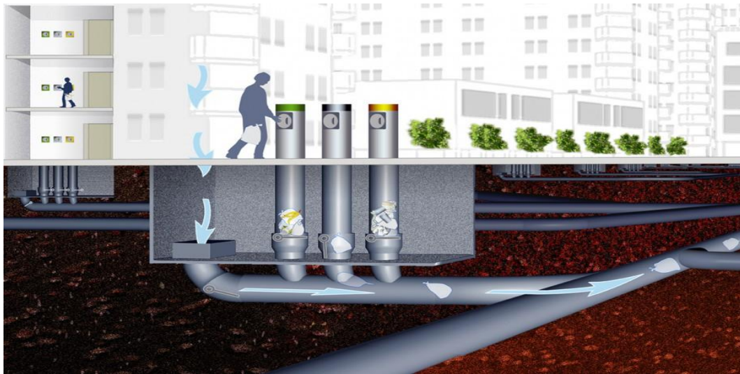
Figure 2.5 : Schéma d'un système de collecte pneumatique des déchets
