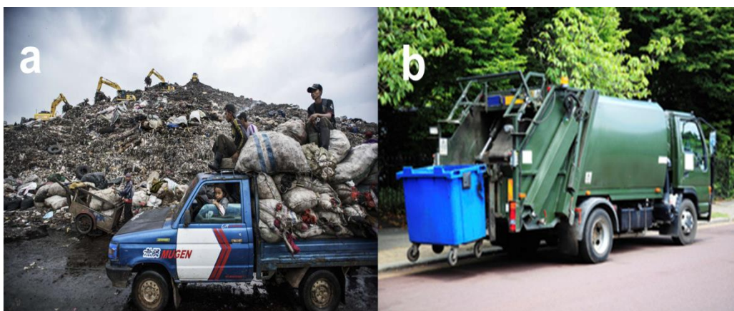
Figure 2.7 : Camions de collecte des ordures ménagères : camion rudimentaire (a), camion à benne tasseuse (b).
