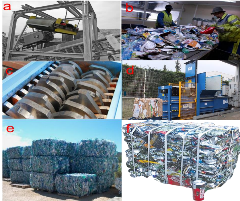
Figure 2.8 : Quelques équipements utilisés dans une station de transfert des déchets : Séparateur magnétique (a), Tapis de tri manuel (b), Broyeurs à cisailles (c), appareil de mise en balles des déchets (d) et vue de déchets compactés en balles (e) et (f).
