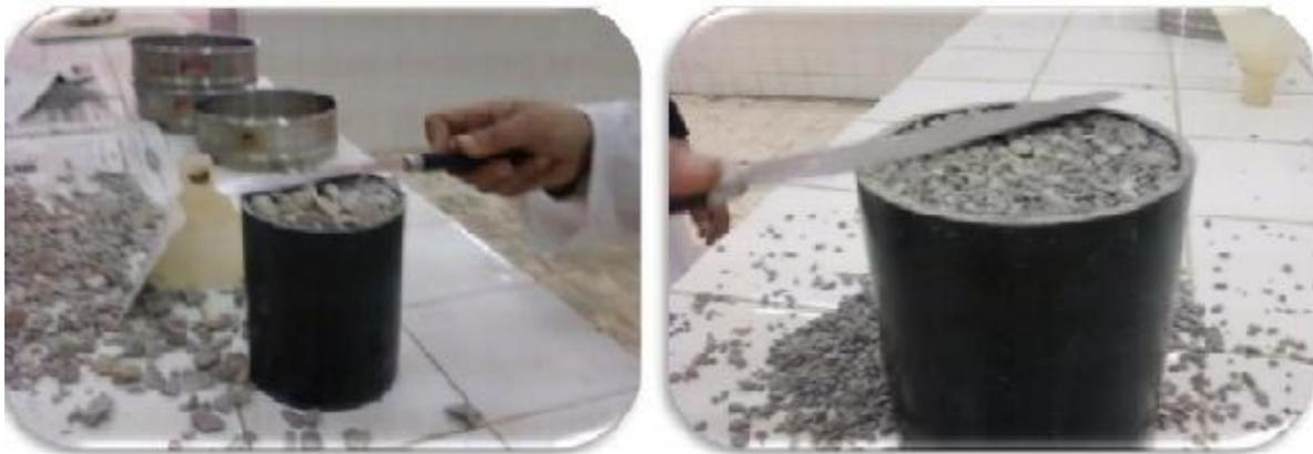
Figure 3. Essai de la masse volumique apparente du gravier
