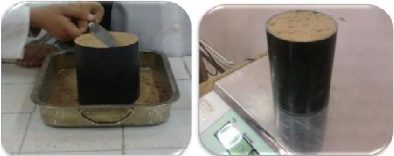
Figure 2. Essai de la masse volumique apparente du sable
