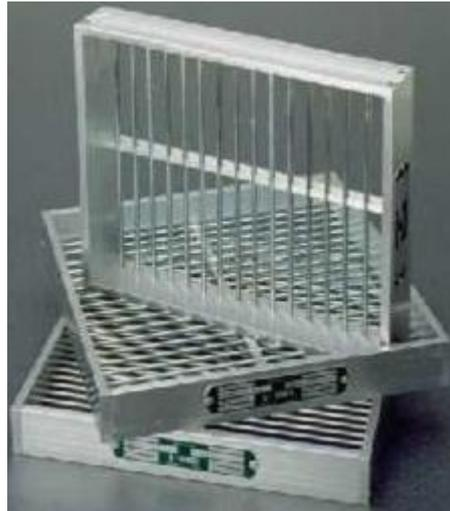
Figure 15. Tamis sur grilles à fente
