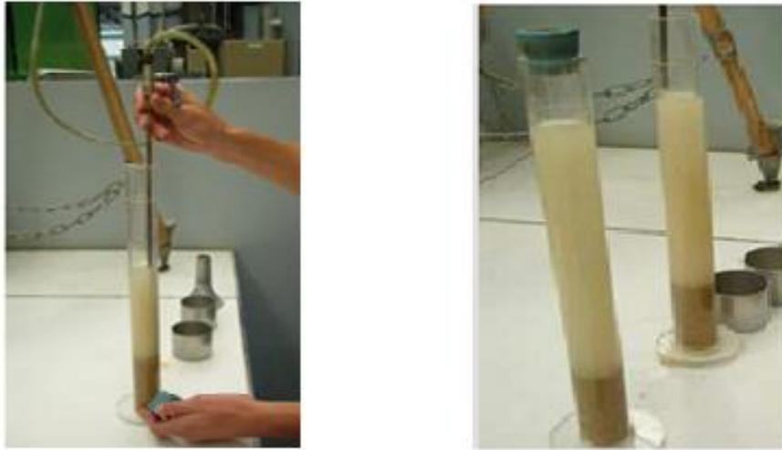
*Figure 17 : Lavage du sable à l'aide d'une solution lavante*
