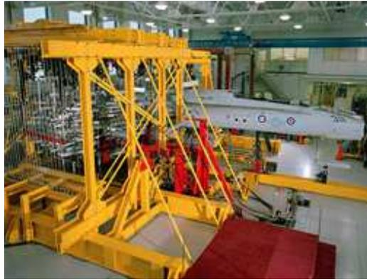
Figure 1 : Essais de fatigue sur l'aile du F/A-18.
