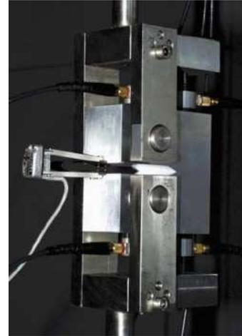
**Figure 9** : Exemple type de technique expérimentale utilisée sur la mesure de longueur de fissure sur éprouvette (CT) sous chargement cyclique.
