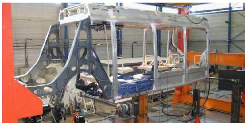
Figure 4 : Machine de fatigue fluage
