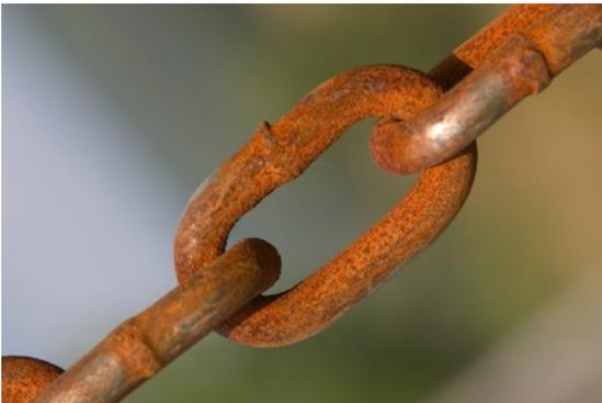
Figure 3. Oxydation d'un anneau en Fer
