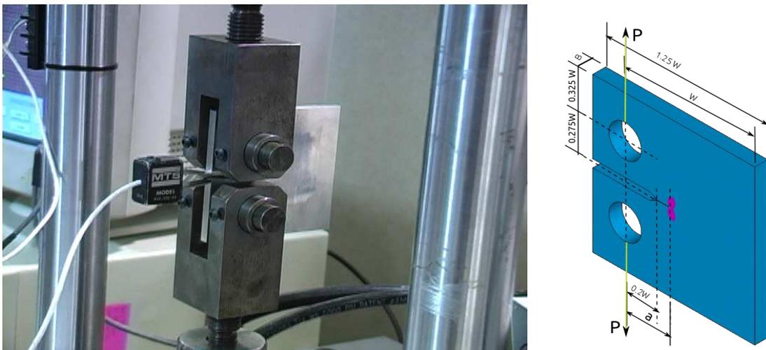
Figure 5 : Montage de l'éprouvette de fissuration sur une machine MTS de fatigue.
