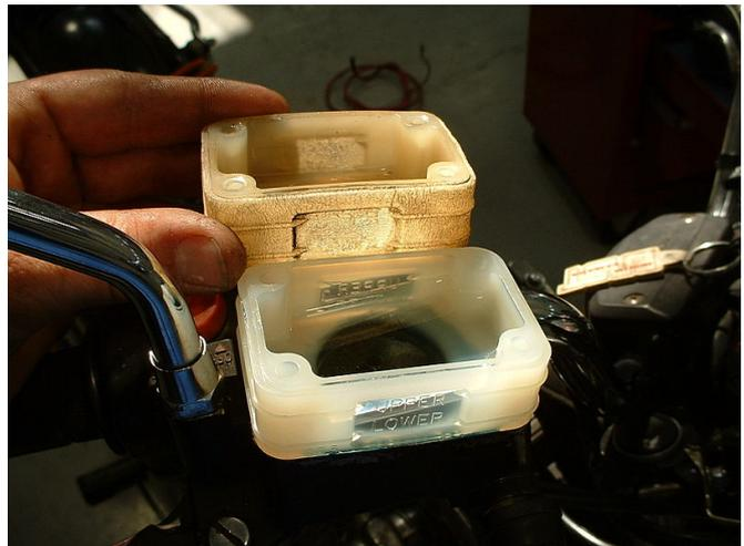
**Figure 2.** Les rayons ultraviolets ont causé la dégradation du plastique.
