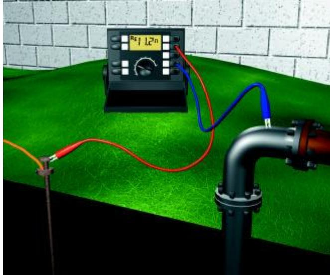
Figure VI. 8 : Principe de mesure de la résistance de terre avec 2 pôles
