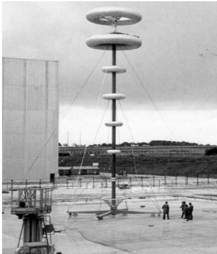
Figure II.27 : Diviseur de tension capacitif -6 MV tension impulsionnelle (Courtesy EDF, Les Renardières, France)
