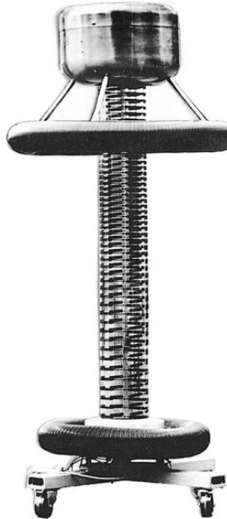
Figure II.22 : Diviseur de tension 300 kV - DC, hauteur 210 m (BTP, Allemagne)
